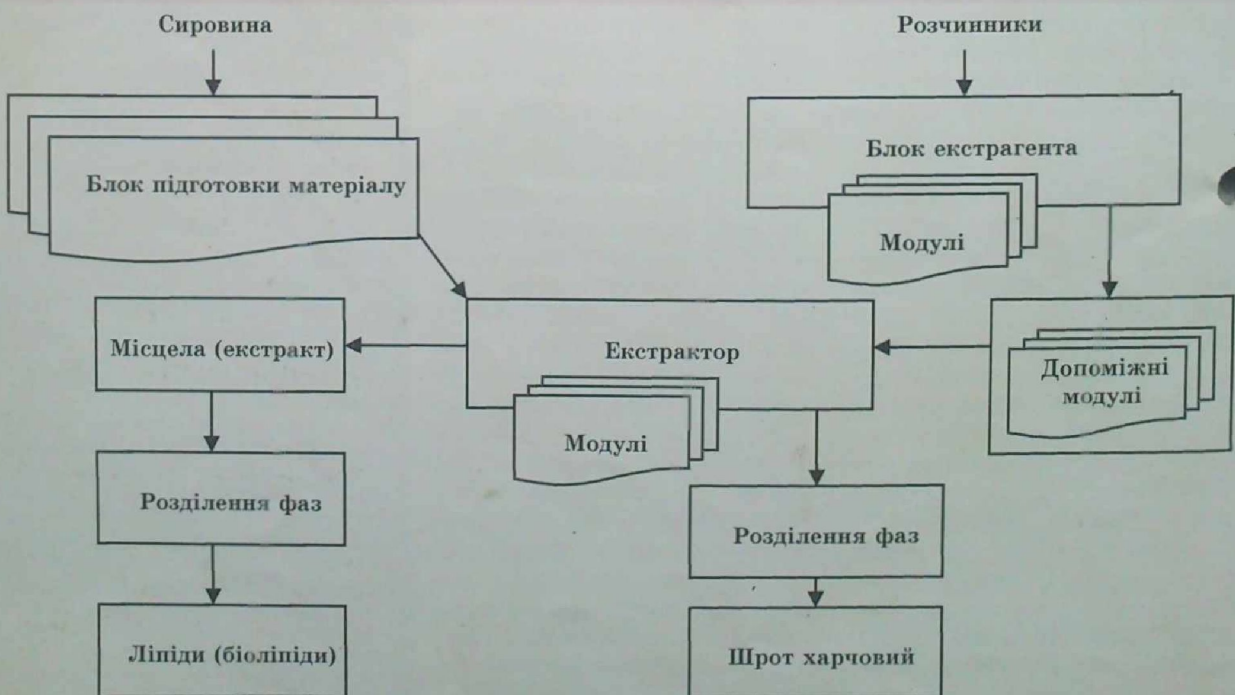
Блок-схема процесу екстракції та експериментальної установки модульно-блочної конструкції.
