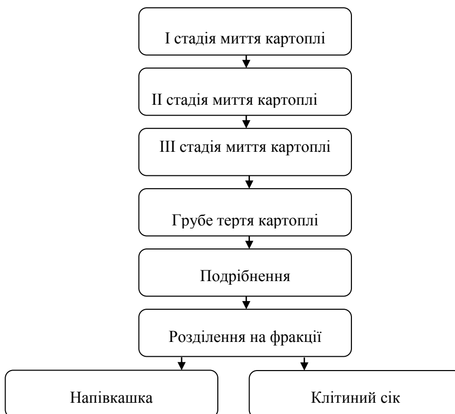
Рисунок 1.4. - Схема виробництва картопляного крохмалю
