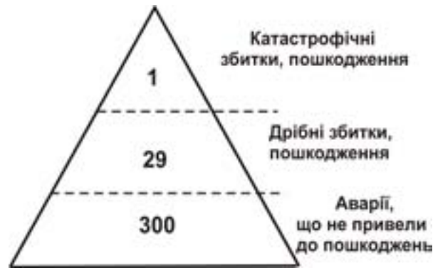
Рис. 2.4. Трикутник Хайнріха – на одне катастрофічне пошкодження припадає 29 дрібних пошкоджень і 300 аварій, що не спричиняють пошкоджень*.
