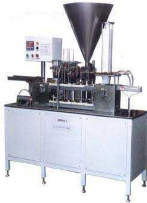
Рис. 1.6 Автомат фасувально-пакувальний УФП-25А для фасування й герметичного впакування настоподібних продуктів
