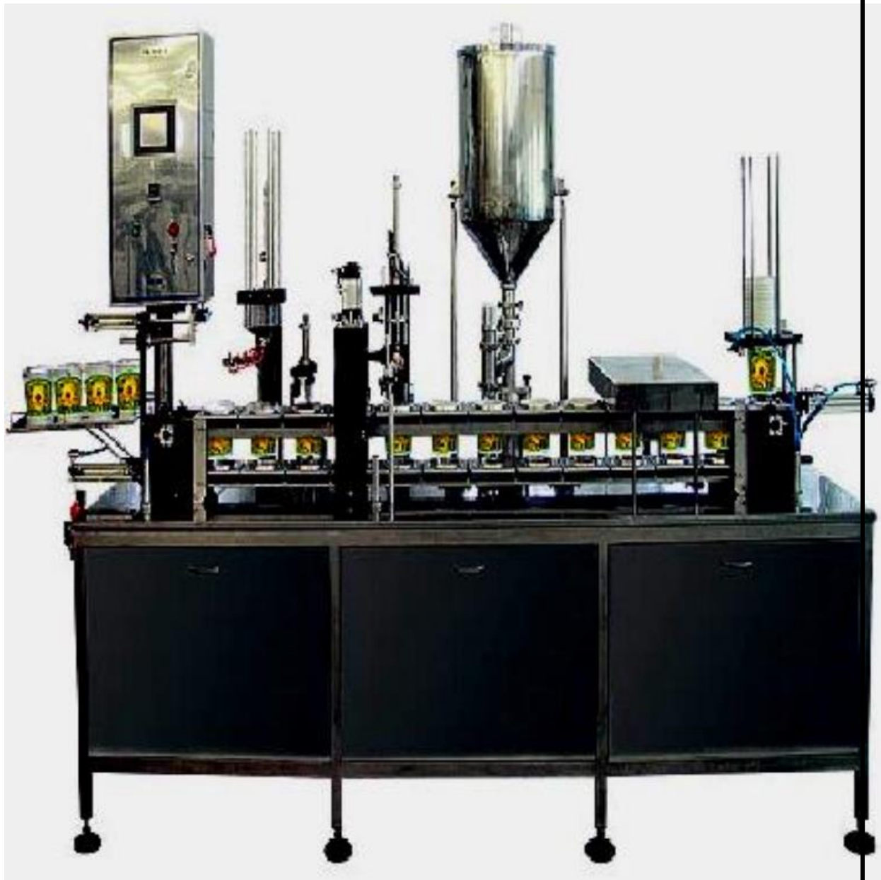
Рис. 1.4 Автоматична система для точного дозування в'язкої продукції, розроблена компанією "Taurus fenix".
