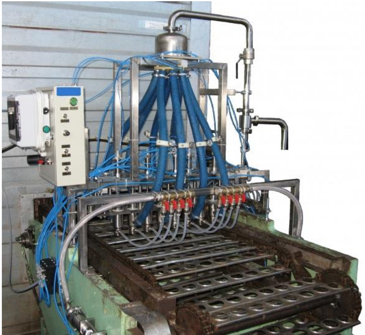
Рис. 1.5 Машина-автомат для дозування морозива ОЛ2-В
