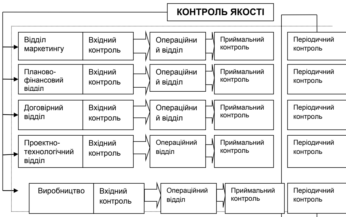
Рис. 2 Система контролю якості продукції з урахуванням роботи всіх підрозділів підприємства
