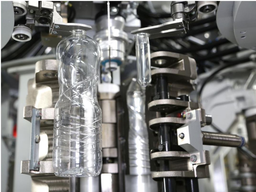
Рис.1.6. Станція видуву лінійної інжекційно-розтягувально-видувної машини (ISBM)
