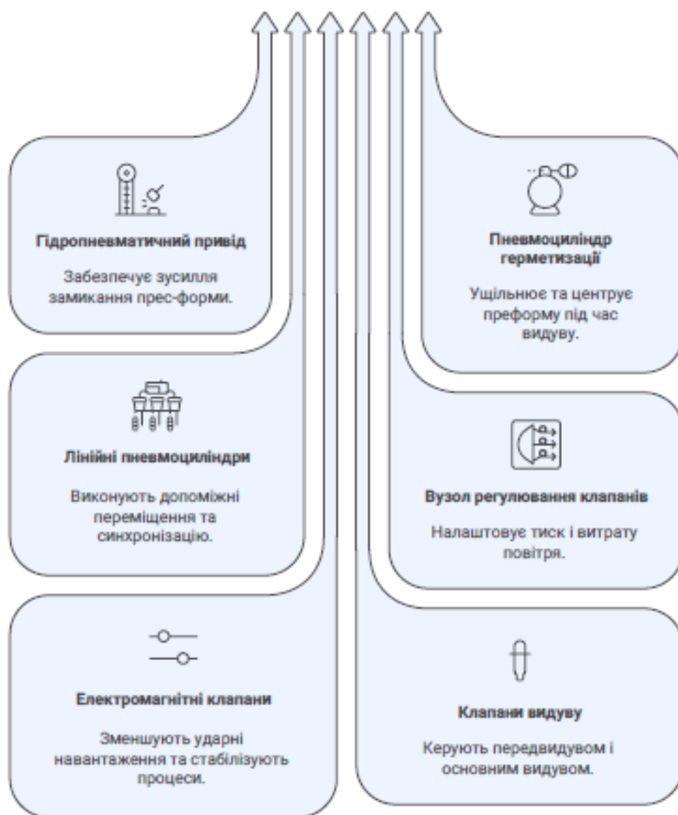
Рис.1.8. Класифікація елементів виконавчі та регулювальні елементи пневматичного приводу автоматичної машини розтягувально-видувного формування ПЕТ-пляшок
