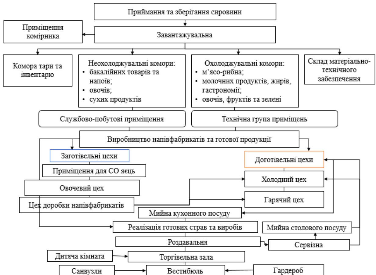
Рис.2.8 – Структурно–технологічна схема організації виробництва дитячого кафе на 80 місць
