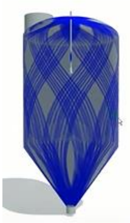
Рис. 2.3 Траєкторія руху рідини ротаційною миючою головкою
