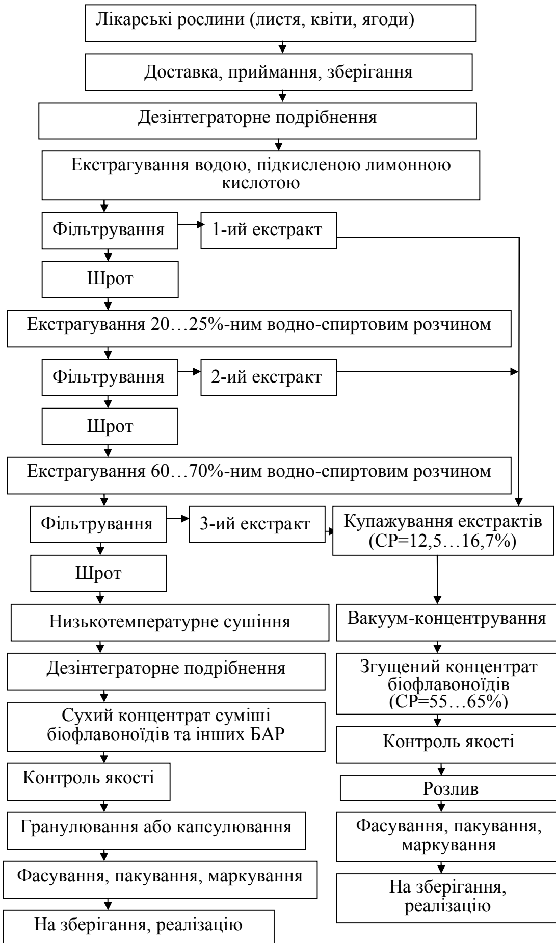
Рис. 1. Принципова технологічна схема отримання сухих та згущених концентратів біофлавоноїдів з лікарської сировини
