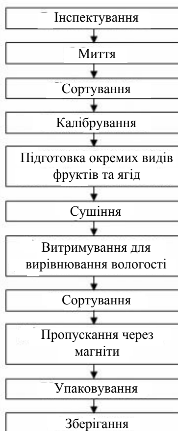
Рис. 1.1 Загальна технологічна схема сушіння плодово-ягідної сировини
