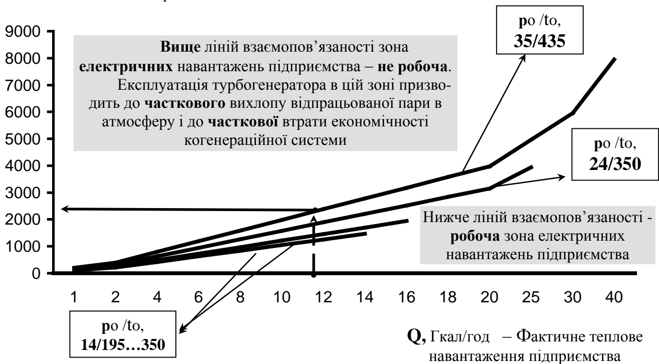
Рис. 3.4. Діаграма взаємозв’язаних величин тепло- та електроспоживання підприємства при використанні турбоагрегатів та бази турбін “Р”
