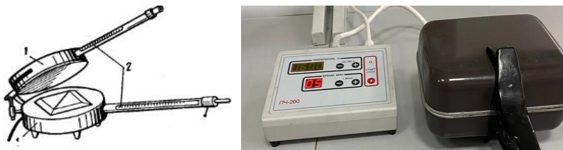
Рис. 2.3 – Прилад Чижової: а – схематичне зображення приладу (1 – металеві плити; 2 – термометри, вставлені в гільзу); б – цифровий прилад; в – сучасний аналог приладу [68]
