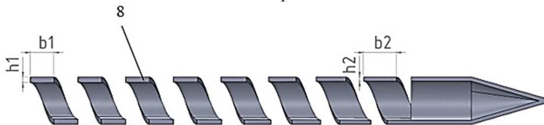
Рисунок 2 – Приклад виконання витків черв'яка
