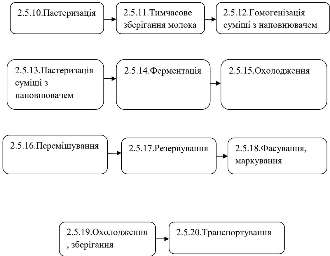
Рис.5.1.Декомпозиція процесів виробництва коктейлю молочного ультра пастеризованого 2.5% жиру з наповнювачем фруктовим «Банан»
