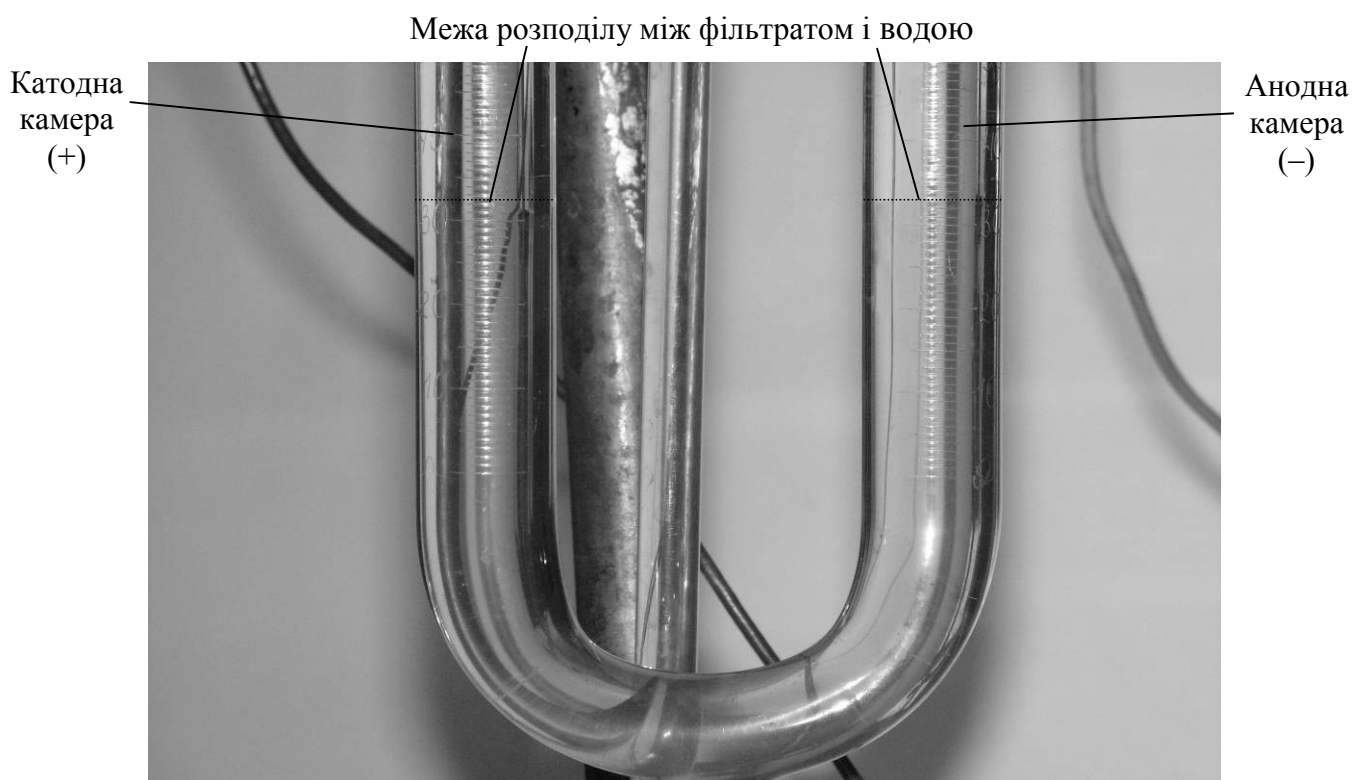
Рис. 1. Прилад Бертон, заповнений водою і фільтратом до початку електрофорезу
