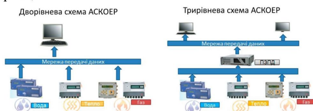
Рис. 1. Дворівнева та трирівнева схема АСКОЕР
