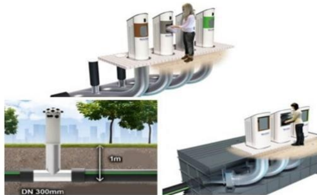
Рисунок 3.1. – Схема вакуумної системи підземного збору відходів
