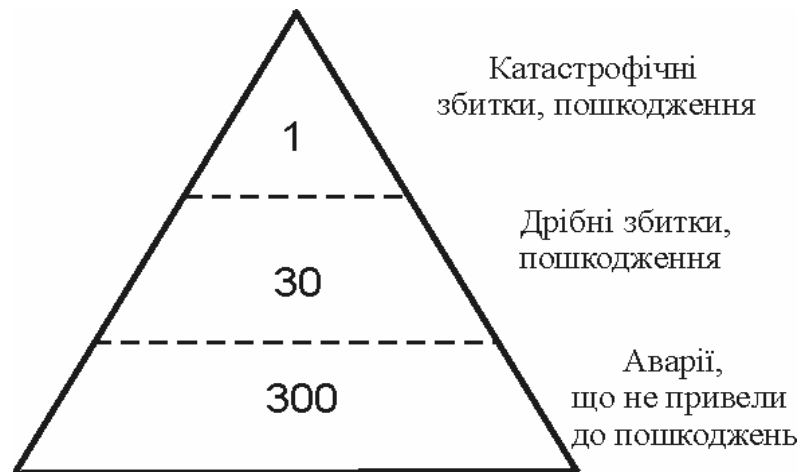
Рисунок 3. Трикутник Хайнриха – на одне катастрофічне пошкодження припадає 30 дрібних пошкоджень і 300 аварій, що не приводять до пошкоджень.
