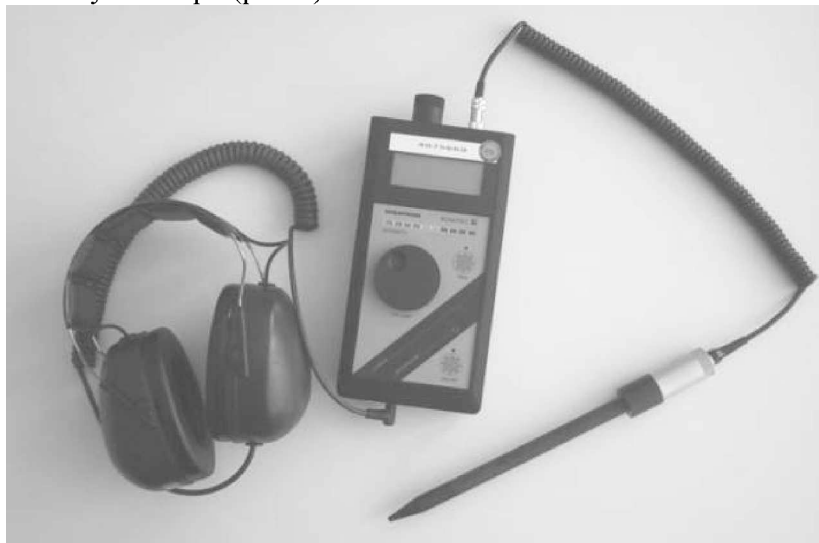
Рисунок 3 – Ультразвуковий детектор пошуку непродуктивних втрат стисненого повітря
