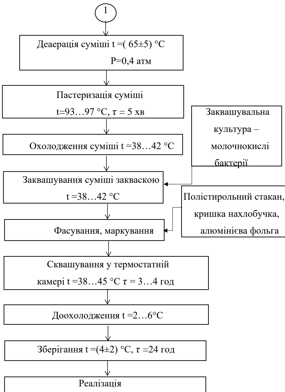
Рис.2.1. Принципово-технологічна схема виробництва йогурту «Турецький»
