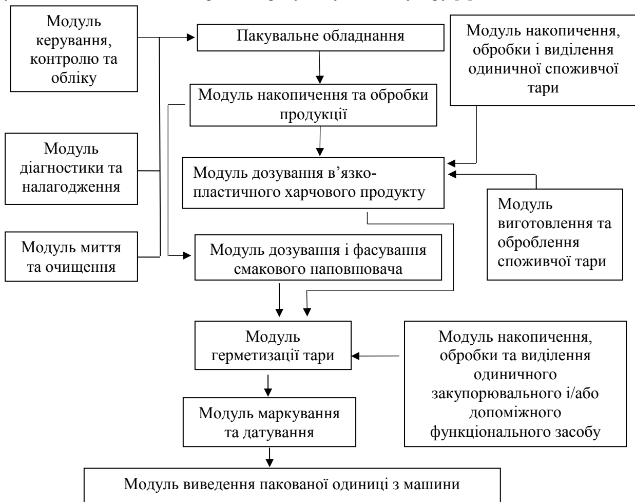
Рисунок 1 - Структура машини для пакування в'язко-пластичних харчових продуктів у споживчу тару
