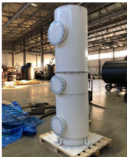
Рис.2.6 – Абсорбер плівковий (хлороводню)
