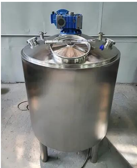
Рис.2.5 – Емальований сульфуратор з охолоджувальною сорочкою та пропелерною мішалкою
