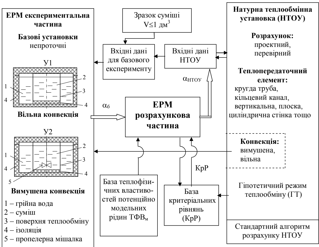
Рисунок 9 – Схема застосування експериментально-розрахункового методу в проектних і перевірних розрахунках теплообмінних елементів СПОВ
