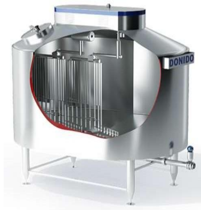
Рис. 1 – Зовнішній вигляд вертикального сировиготовлювача для твердих сирів марки DONI®Double O Vat HC
