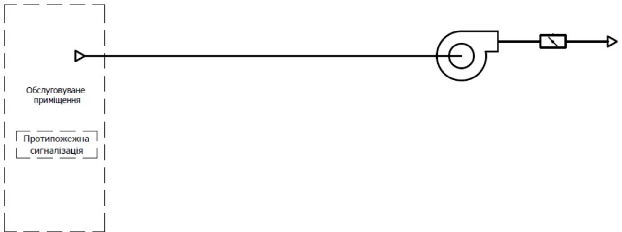
Рис. 1.2 Витяжна система вентиляції
