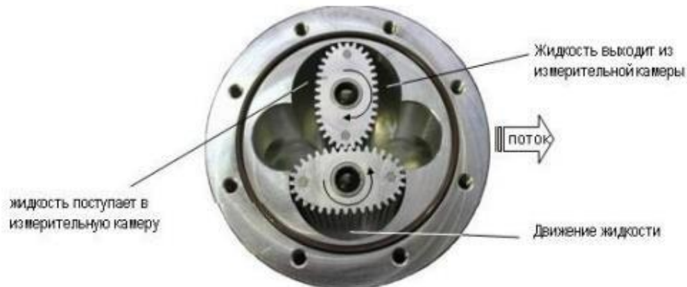
Рис. 2.10 Принцип дії витратоміра з зубчатим колесом.
