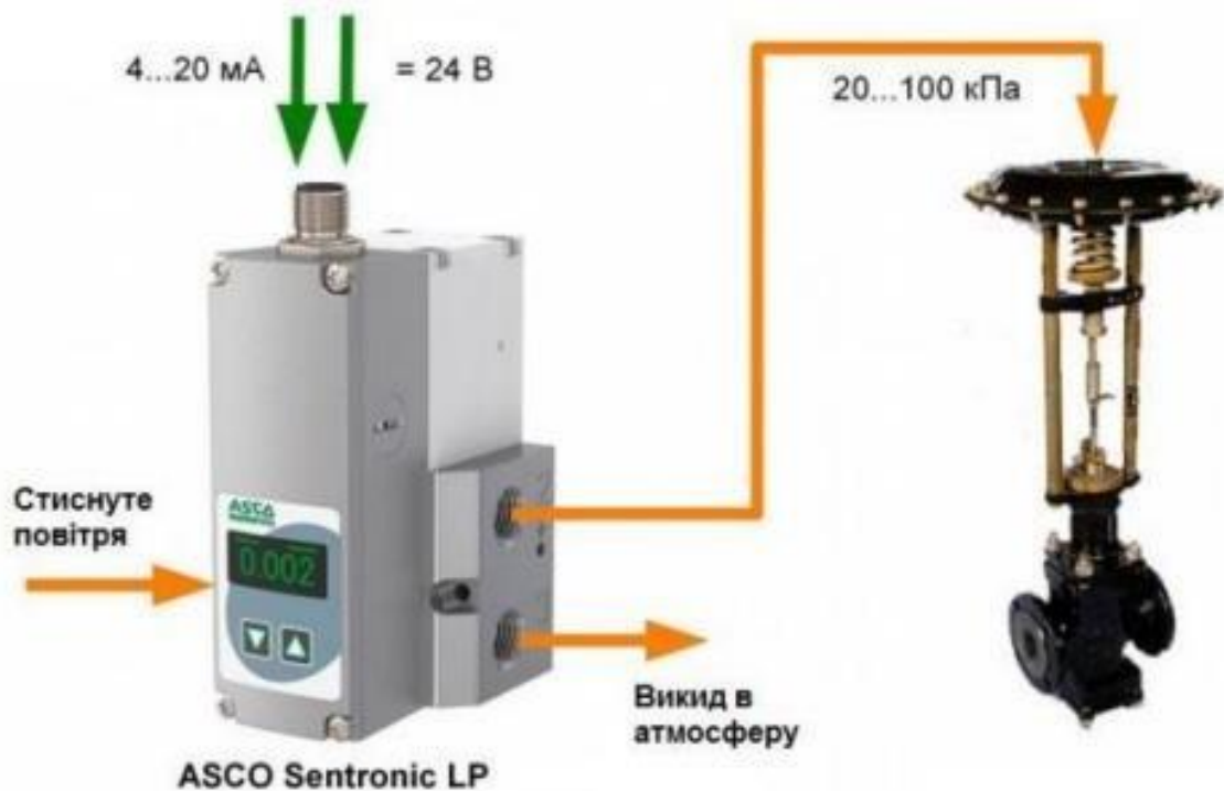
Рис. 2.5 Схема з'єднання ЕПП ASCO NUMATICS Sentronic LP і регулюючого клапана.
