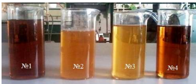
Рисунок 4 – Склянки з розчинами: 1) вихідний вапнований модельний розчин; 2) розчин I карбонізації; 3) розчин II карбонізації; 4) розчин після розчинення твердої фази \text{CaCO}_3 .
