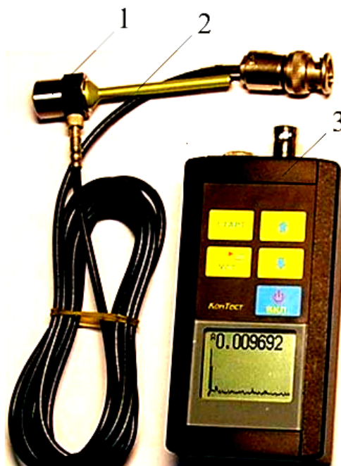
Рис. 1. Прилад для вимірювання параметрів коливань “Віброметр 107В”: 1 - акселерометр; 2 – щуп; 3 – віброметр
