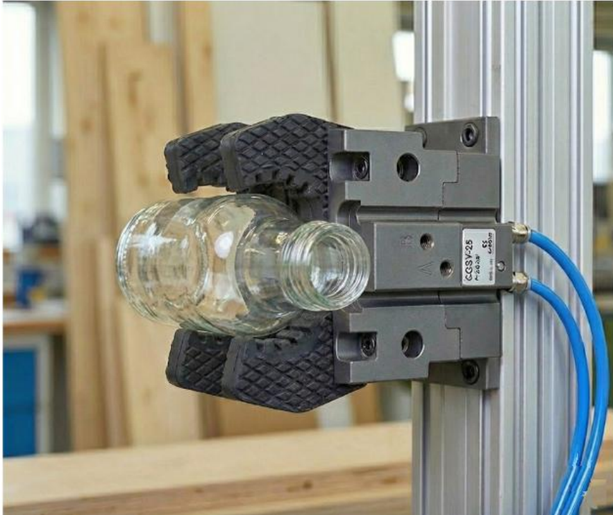
Рис. 3.7. Губки з призматичним вирізом, що забезпечує самоцентрування пляшок або банок.
