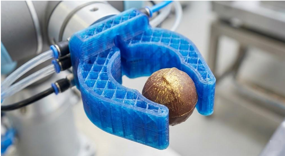
Рис. 3.9. Губки спеціальної форми, що повторюють контур цукерки або іншого крихкого виробу, надруковані з меншим відсотком заповнення для забезпечення певної пружності.
