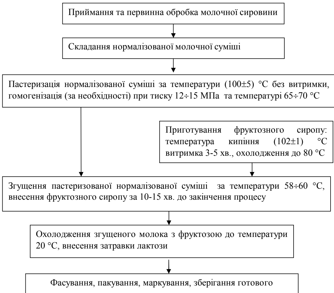
Рис. 5. Параметрична схема виробництва ЗМК з фруктозою
