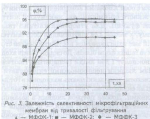
Рис. 3. Залежність селективності мікрофільтраційних мембран від тривалості фільтрування
