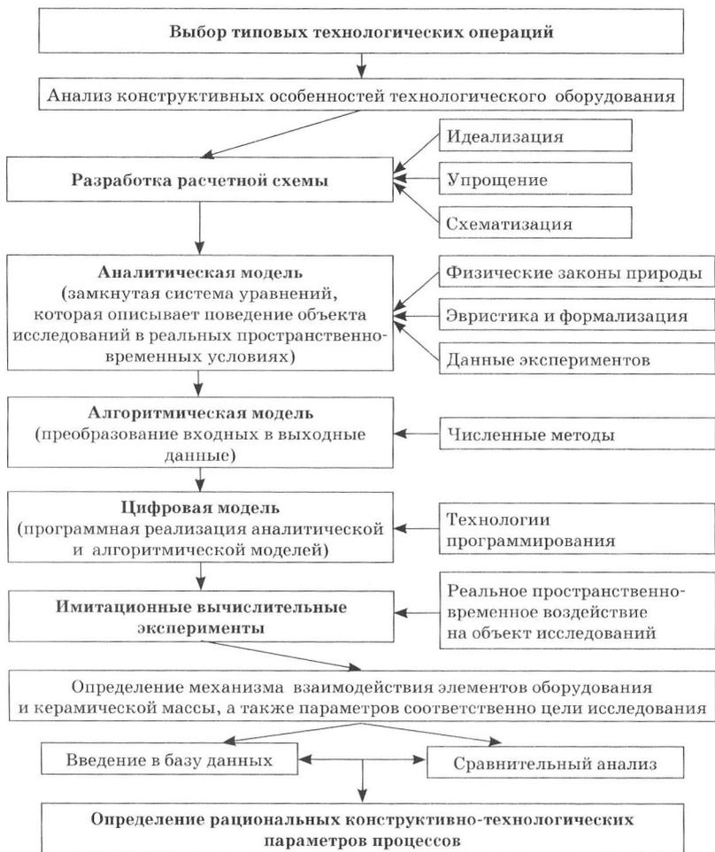
Рис. 1. Схема информационной технологии проектирования
