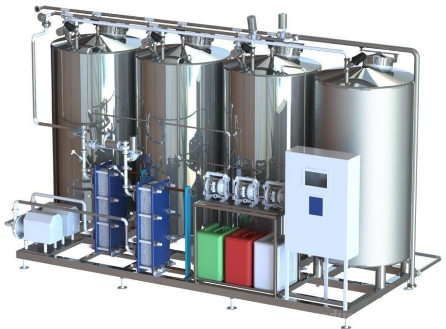
Рис. 6.1. Зовнішній вигляд конструкцій CIP-мийки: а – пересувна; б – стаціонарна
