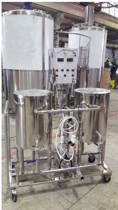
Рис. 6.1. Зовнішній вигляд конструкцій CIP-мийки: а – пересувна; б – стаціонарна
