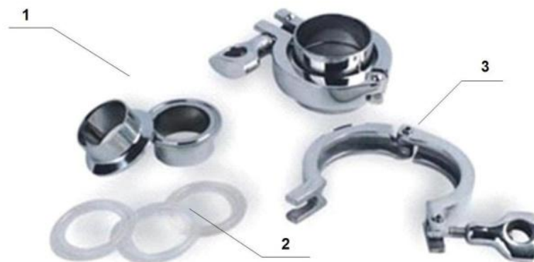
Рис.6.27. Конструкція швидкоз'ємного гігієнічного затискання типу Clamp (муфта Кламп); у зібраному стані складається з 4 частин: 1 - штуцер Кламп(манжета Кламп) – 2 шт.; 2 – кільце ущільнююче (ущільнювач) – 1 шт.; 3 – хомут Кламп – 1 шт.
