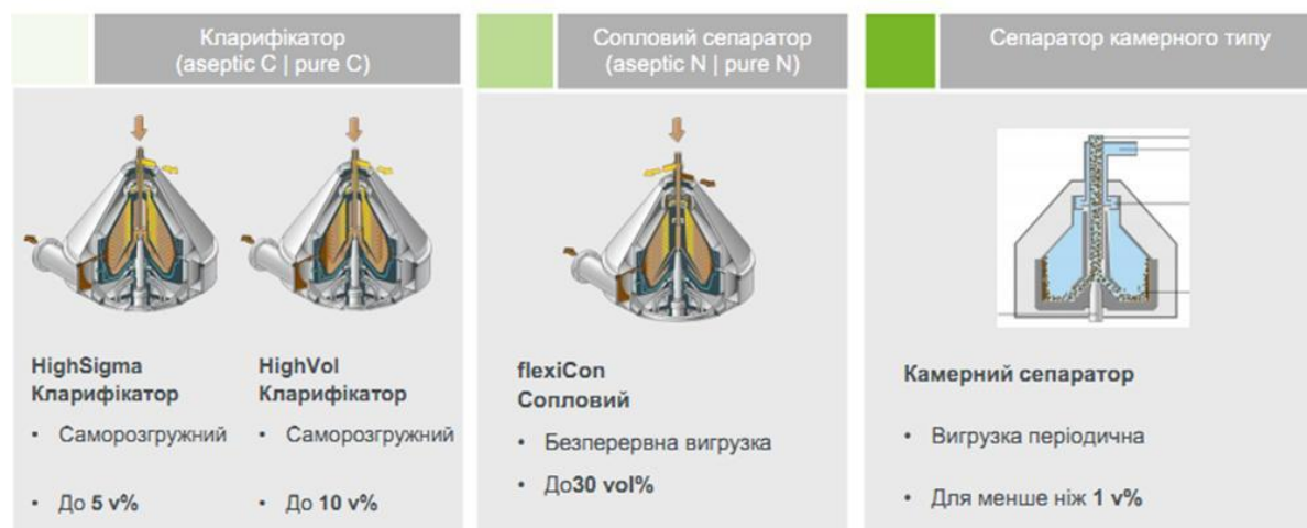
Рис.8.22. Мультимодульна система сепарування з різними типами барабанів
