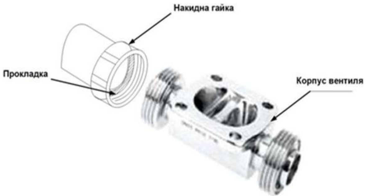
Рис. 6.26. Конструкція різьбового з'єднання за допомогою накладної гайки
