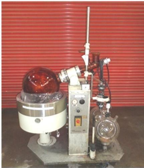
Рис. 8.28. Загальний вигляд лабораторного роторно-плівкового випарника
