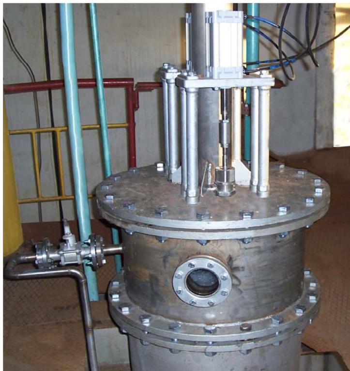
Рис.2. Реализация механотронной подсистемы для управления процессами массообмена в РК.
