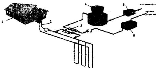
Рис. 2 - Схема охлаждения оборотной воды через грунтовый контур теплового насоса: 1 – отопляемый объект, 2 – грунтовый тепловой насос, 3 – теплообменник, 4 – градирня, 5 – сборник охлажденной воды, 6 – сборник горячей воды.
