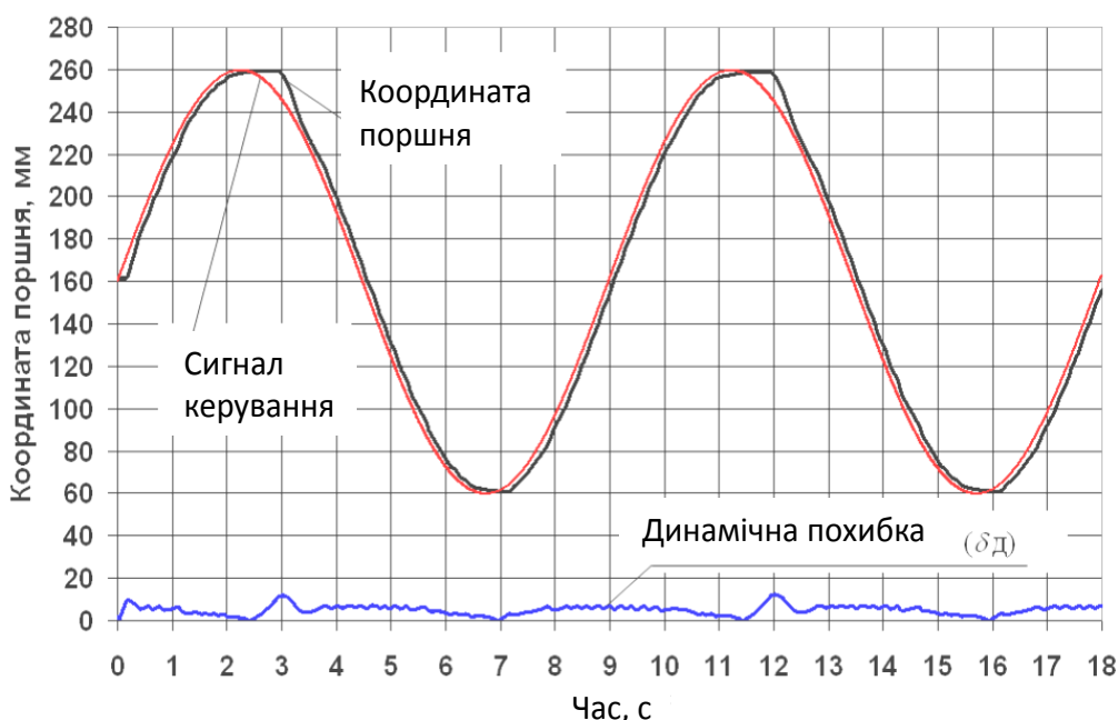
Рисунок 2 – Графічна інформація про положення вихідного елемента виконавчого механізму (затвора регулюючого органу). Похибка позиціонування: |\delta_{пі}| \leq 1\text{мм} , перерегулювання: \sigma_i \leq 7\%
